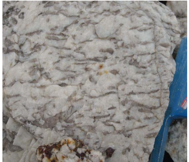
图 3-15. 文象结构伟晶岩：吸收带（1400，1920 强，2200）
